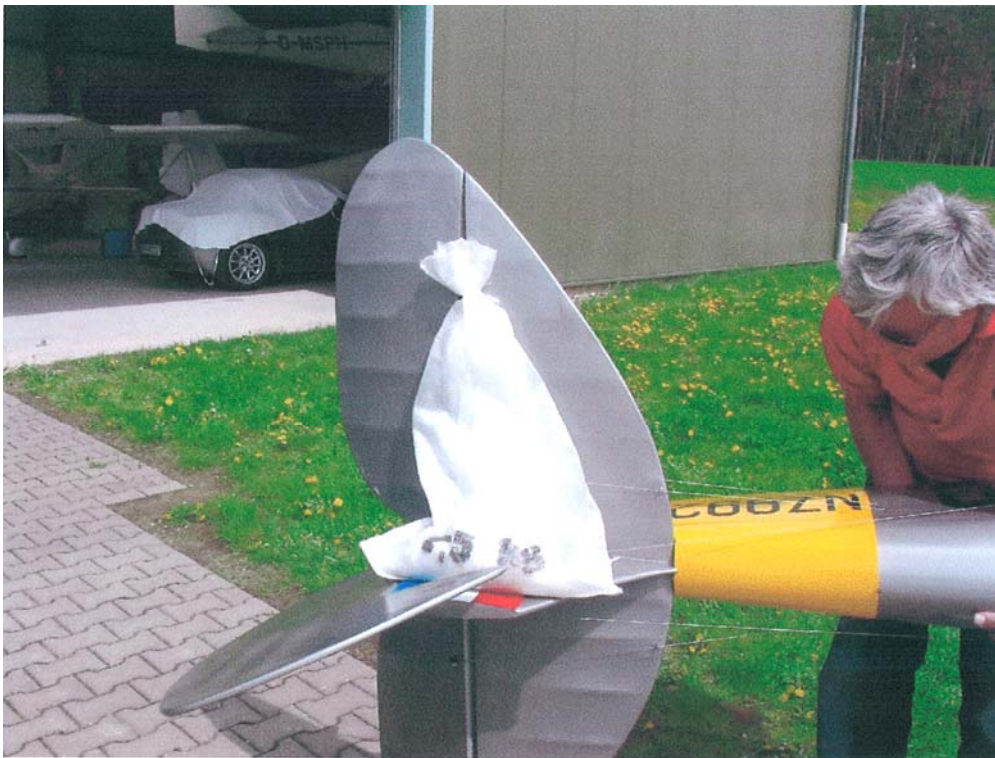
Belastung Seitenleitwerk rechts 2,5kg
