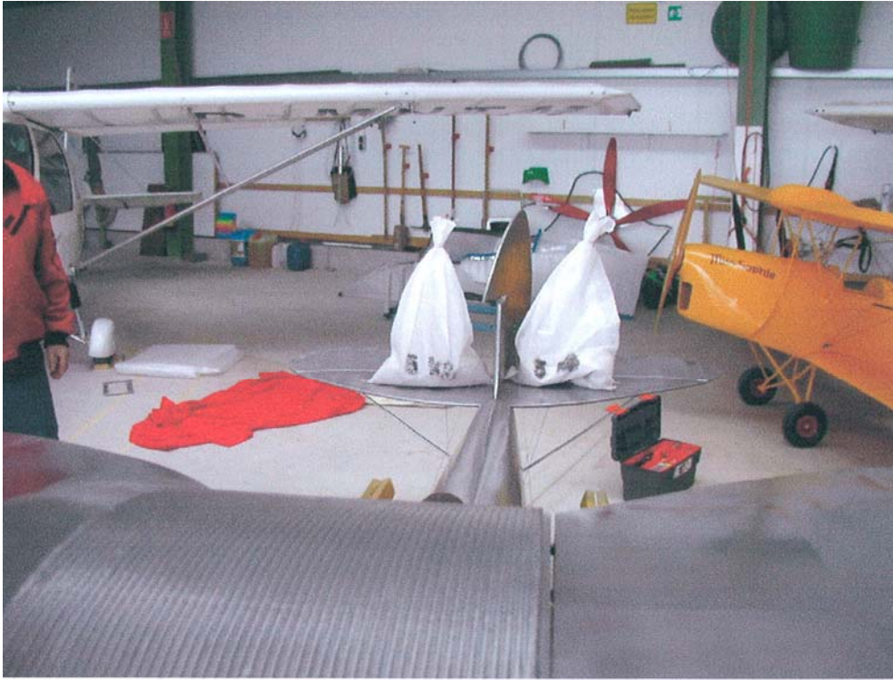
Belastung Höhenleitwerk negativ 2 x 5kg
