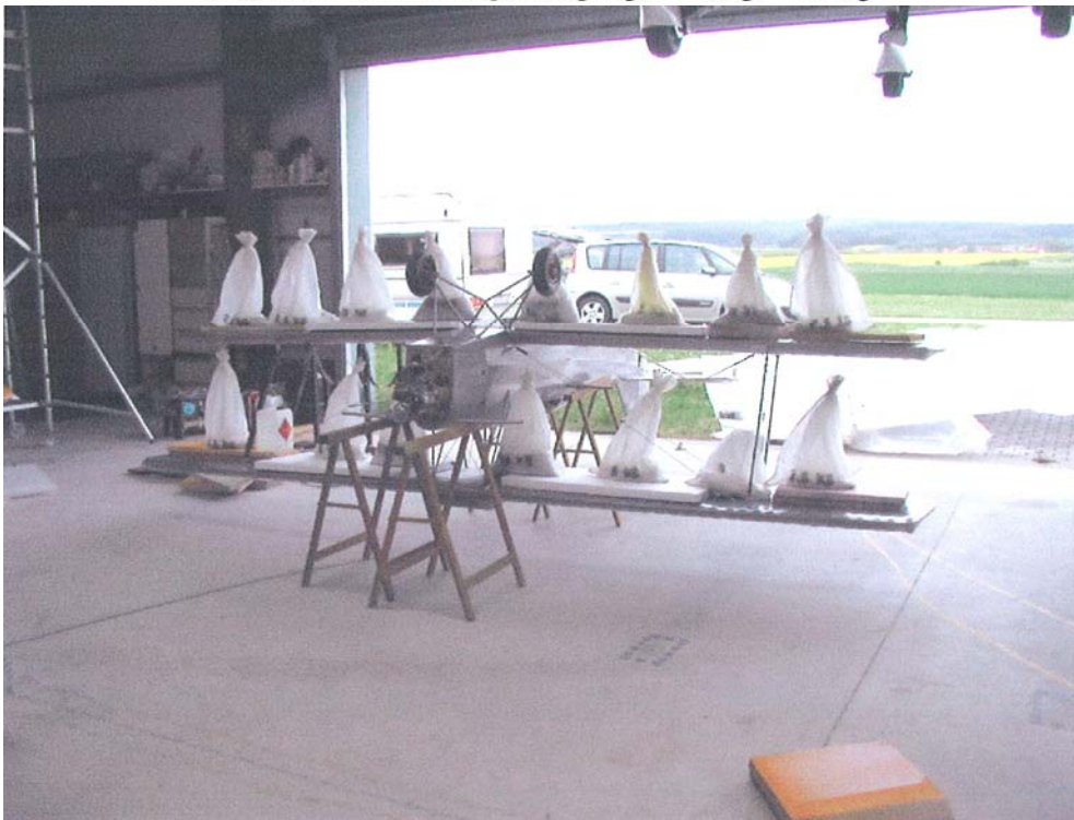
2,5 / 5 / 5 / 10 // 10 / 5 / 5 / 2,5 unten 2,5 / 5 / 5 / 10 // 10 / 5 / 5 / 2,5 oben positive Belastung, Rückenlage 3g = 90kg
