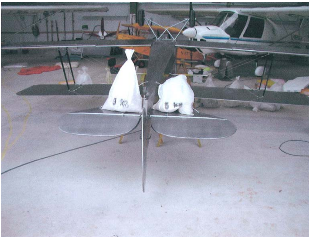
Belastung Höhenleitwerk negativ 2 x 5kg
