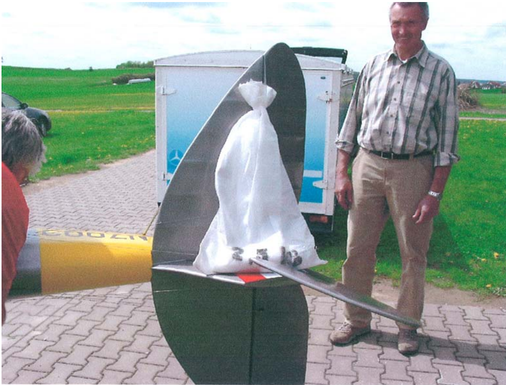
Belastung Seitenleitwerk rechts 2,5kg
