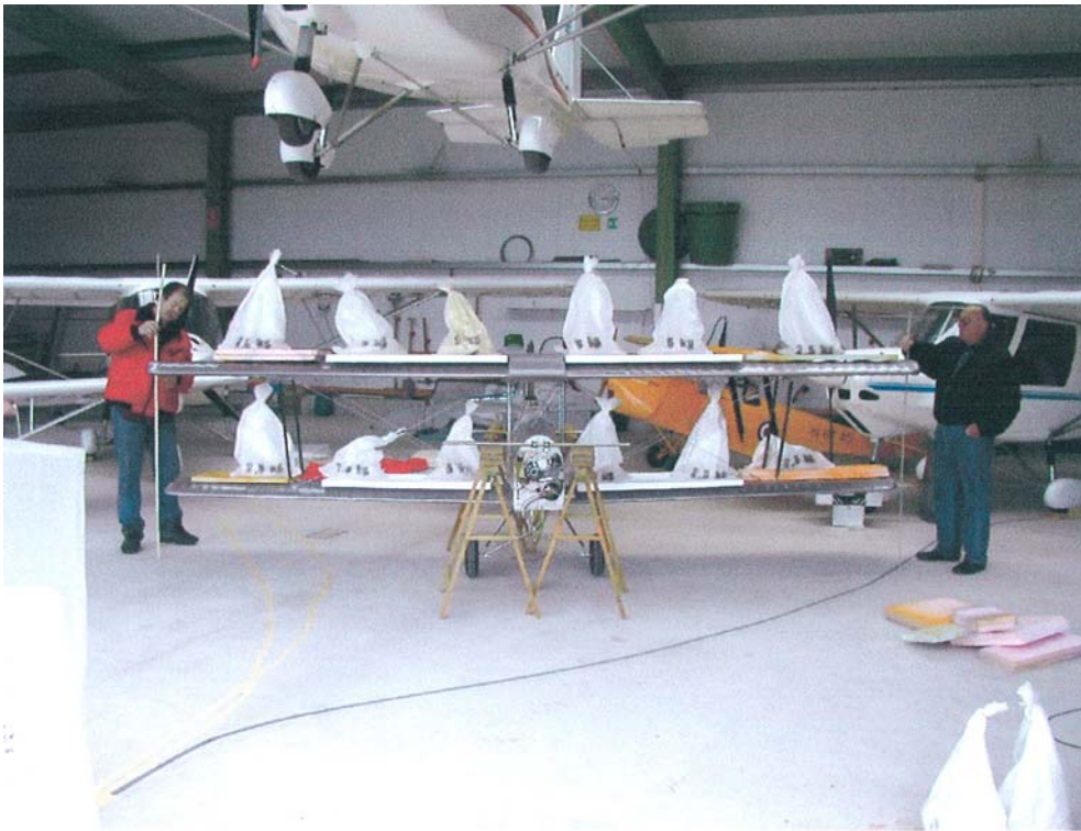
2,5 / 5 / 5 // 5 / 5 / 2,5 oben 2,5 / 2,5 / 5 // 5 / 2,5 / 2,5 unten negative Belastung, Fluglage -1,5g = 45kg
